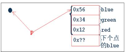
设p当前指向的点的颜色值=0x123456,则此值在内存中的存放顺序为: 0x56,0x34,0x12。由于p的类型为long \*, 所以\*p=0x??123456;现假定新的颜色color=0x00FFFF(即 red=0,green=0xFF,blue=0xFF),则
